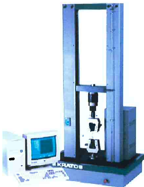
Fig. 11: representação da maquina de tração
